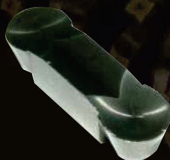
Inserto original desgastado
