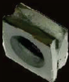
Inserto original desgastado
